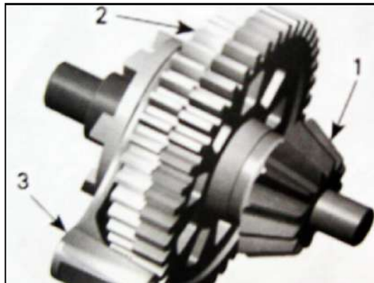
1. Bevel gear 2. Sliding gear 3. Shift fork
